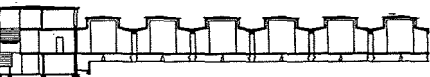
Fig. 35. Børnehave i Zürich. Maal 1:1000. Snittet viser 6 af de 8 Klasseværelser, der foruden Skydevinduer har hver sin Lanterne til at supplere Belysningen. Den specielle Tagform vilde have været vanskelig at udføre i andet Materiale end Jernbeton.
